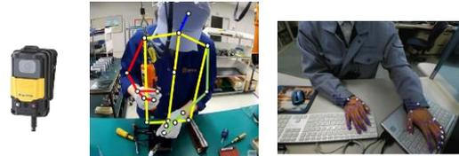
カメラに映る作業者の動作を監視して飛ばしがちな作業を確実に実施しているリアルタイムに検出します。
