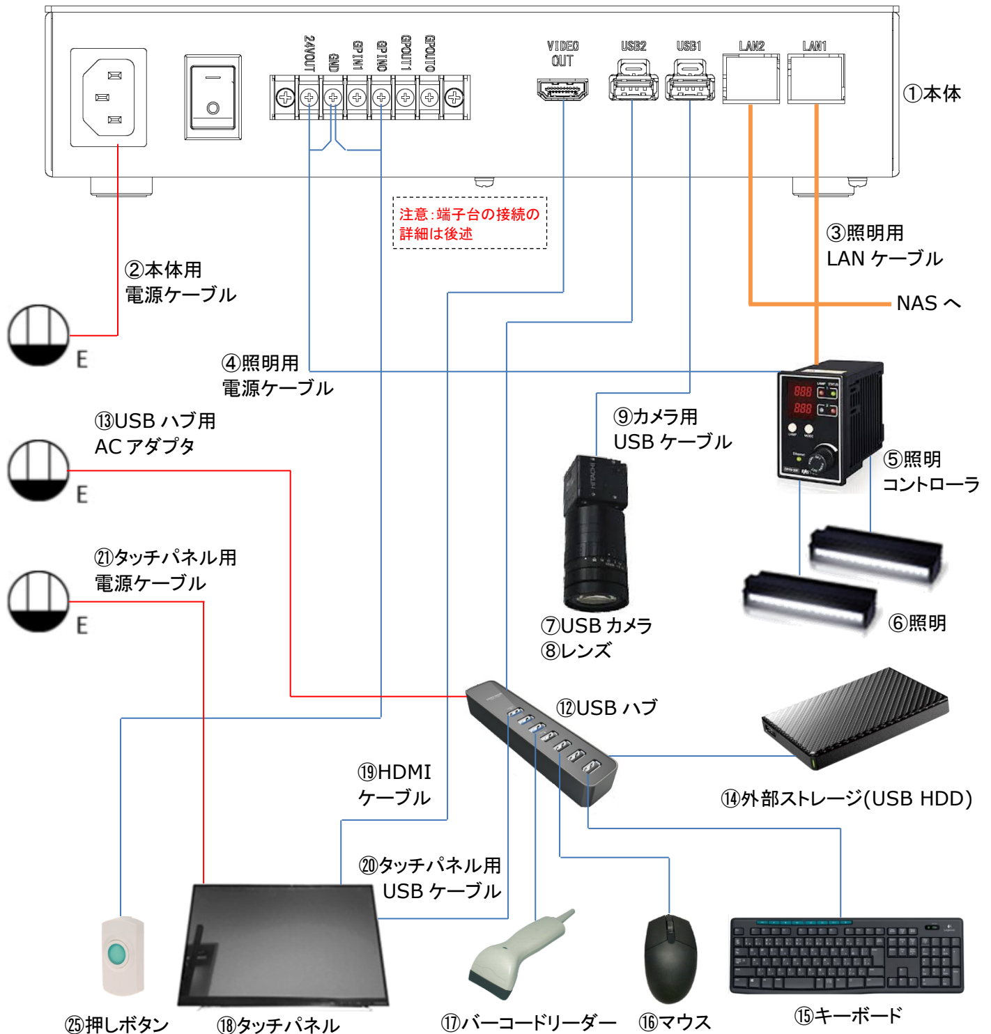
図 2-4 機器構成・接続図 (東芝テリーを用いたカメラ 1 台構成の場合)
