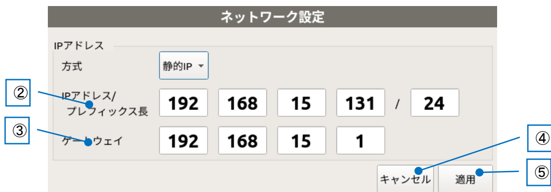
図 10-8 ネットワーク設定(静的 IP 方式)
