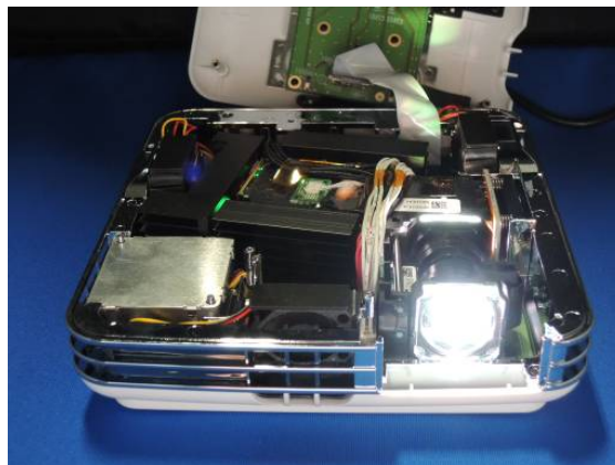
今回試作した高輝度（500lm）小型プロジェクター
